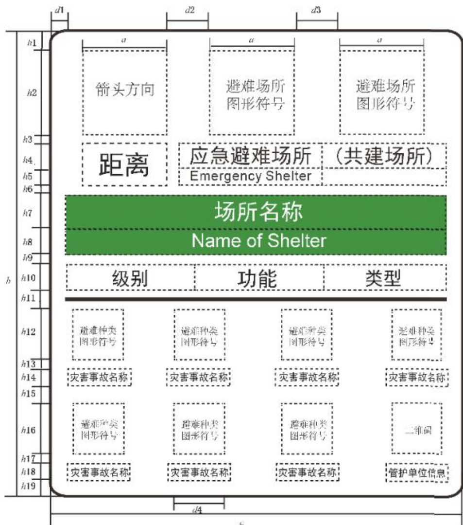
图中 a 为避难场所图形符号、箭头边长尺寸, b=4.9a , c=3.3a , d1=d3=0.2a , d2=0.5a , d4=0.6a , h1=h5=h7=h8=h13=h16=h17=0.2a , h2=a , h3=h11=h15=0.1a , h4=h6=h10=h12=0.3a , h9=0.4a , h14=0.6a 。 图中文字和图形符号整体水平居中、垂直居中, 间距均匀; 中文字号大于英文字号; 右侧边缘适当与文字留有间距。
