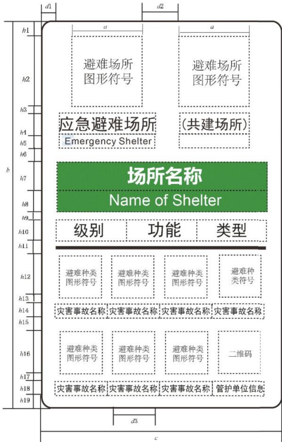
图中 a 为避难场所图形符号边长尺寸, b=5.5a , c=3.3a , d1=0.2a , d2=0.5a , d3=0.6a , h1=h5=h6=h11=h14=h15=h18=h19=0.2a , h2=a , h3=h9=h13=h17=0.1a , h4=h8=h10=0.3a , h7=0.4a , h12=h16=0.6a 。 图中文字和图形符号整体水平居中、垂直居中, 间距均匀; 中文字号大于英文字号; 右侧边缘适当与文字留有间距。
